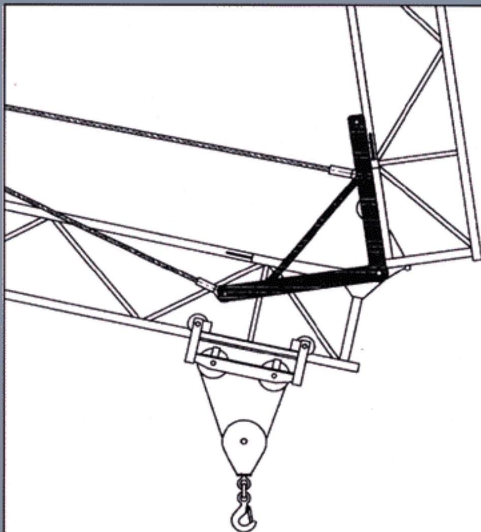
**Brevetto GRU DALBE per l'allineamento automatico aereo del braccio. L'affidabilità assoluta del funzionamento esclusivamente meccanico rende il nostro sistema esemplare per sicurezza e semplicità.**
